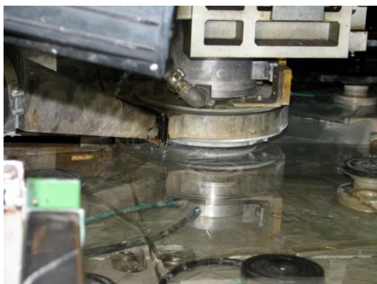
Rys 1. Cięcie i szlifowanie formatek szkła
