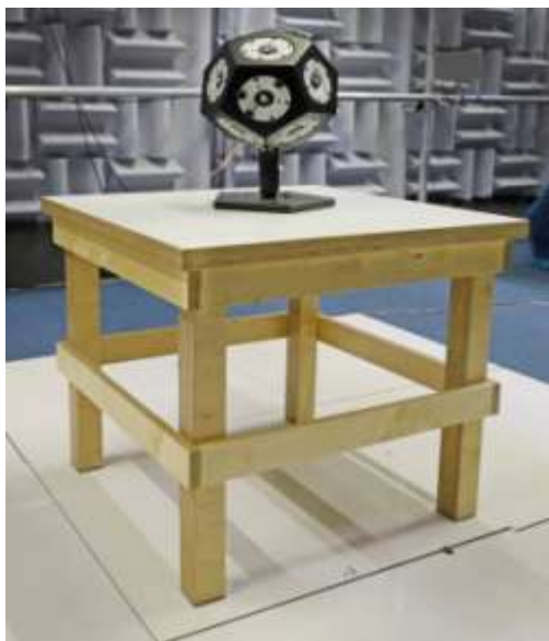
Rys. 6. Specjalny stolik pomiarowy do pomiaru poziomu ciśnienia akustycznego emisji spełniający wymagania [9] wykonany w Centralnym Instytucie ochrony Pracy – Państwowym Instytucie Badawczym
