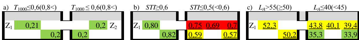
Rys. 4. Wyniki obliczeń wariant adaptacji 2: a) czasu pogłosu dla częstotliwości 1000 Hz T_{1000} (w pomieszczeniu nadawczym od źródła Z_1 , w pomieszczeniu odbiorczym od źródła Z_2 , b) wskaźnika transmisji mowy STI od źródła Z_1 , c) poziomu dźwięku A mowy L_A od źródła Z_1 .
