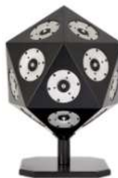
Rys. 1. Obecnie wykorzystywane w Centralnym Instytucie Ochrony Pracy – Państwowym Instytucie Badawczym źródła hałasu ultradźwiękowego: a) dwunastogłośnikowe, b) dwudziestogłośnikowe.
