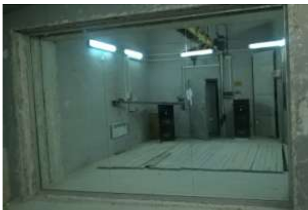
Rys. 1. Ściana szklana zamontowana na stanowisku badawczym ITB.
