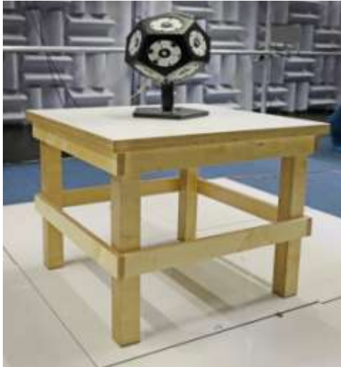
Rys. 1. Stolik pomiarowy wg PN EN ISO 11201 [6] wykonany w laboratorium CIOP-PIB.
