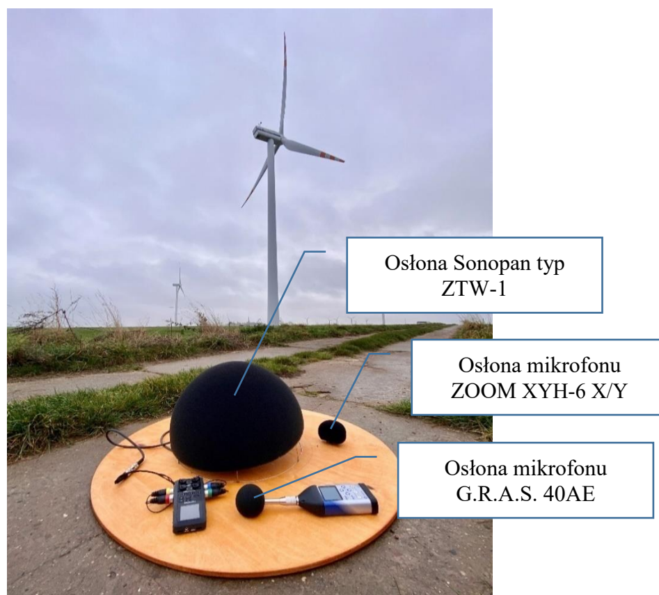
Rys. 8. Zestaw osłon zastosowany do pomiaru hałasu turbin wiatrowych
