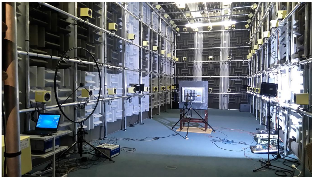
Rys. 8. Komora do badań akustycznych CIOP-PIB
